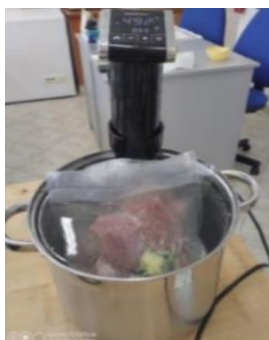
Obr. 3.2 Vodný kúpeľ s nastaviteľným sous vide teplomerom
